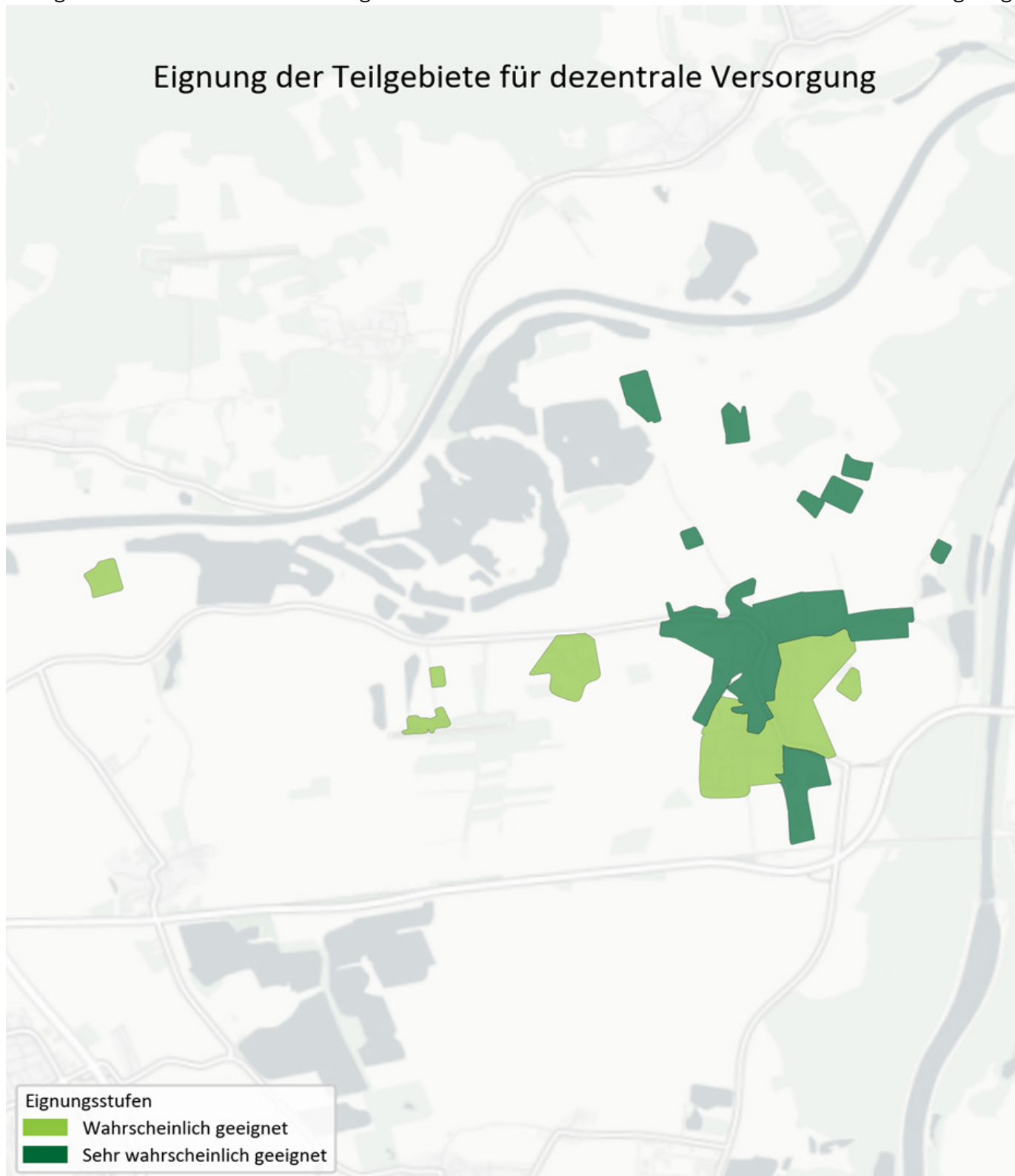
Abbildung 21: Voraussichtliche dezentrale Wärmeerzeugung für das Jahr 2045
