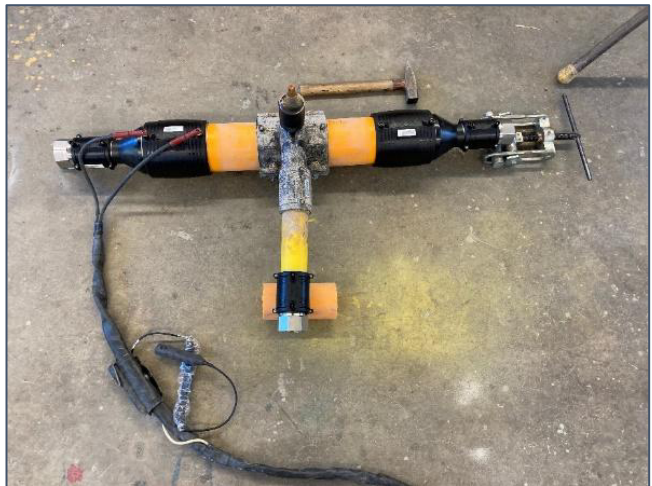
Abbildung 7: Vorbereitung der Prüflinge für H2 Prüfungen
